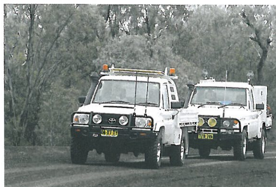
(写真上)農場内を走る新旧の79ユート。工具やポンプを積んだ特注の後部荷台は車を入れ替える度に荷台ごと載せ換えて代々使っているという。UHF無線機は必須の装備。(写真左)最新のVDJ79は大型のジョンディア製トラクタに牽引された収穫用の大きな農機が公道を走るときのエスコート・ビークル(先導車)としても利用されるため「OVERSIZE」という表示板がルーフに付く。
